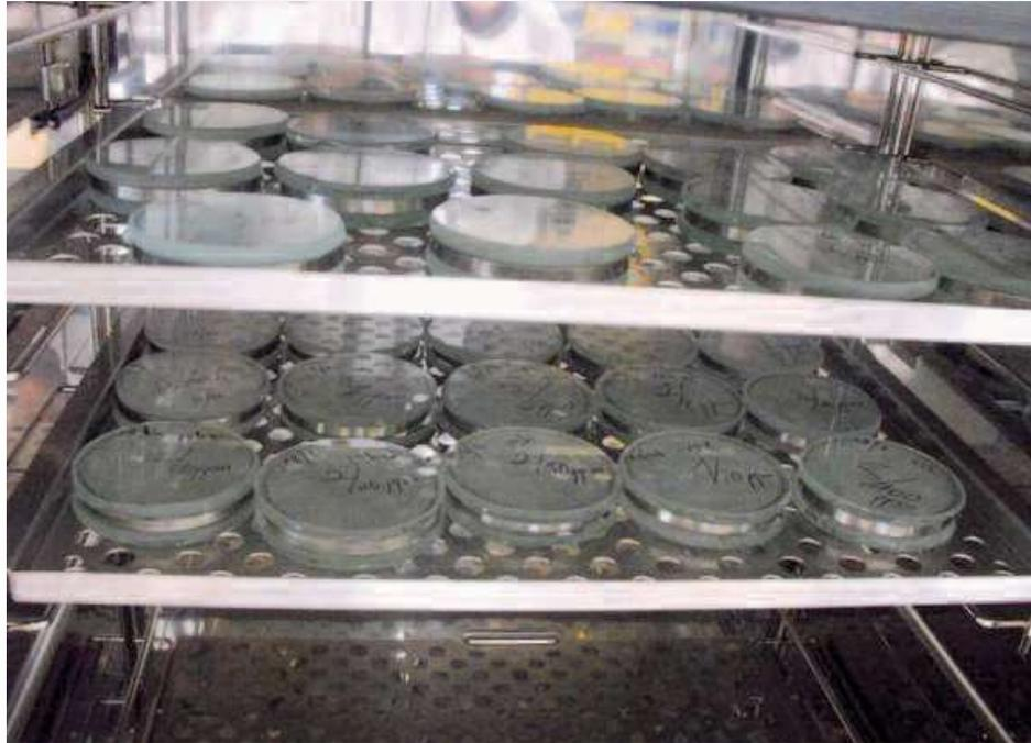
Capsules contenant les varroas en test, placées dans une enceinte thermostatée.
